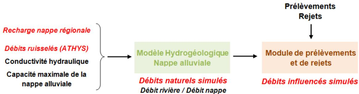
*Illustration 30 - Synoptique du modèle hydrogéologique des échanges nappes-rivières*
